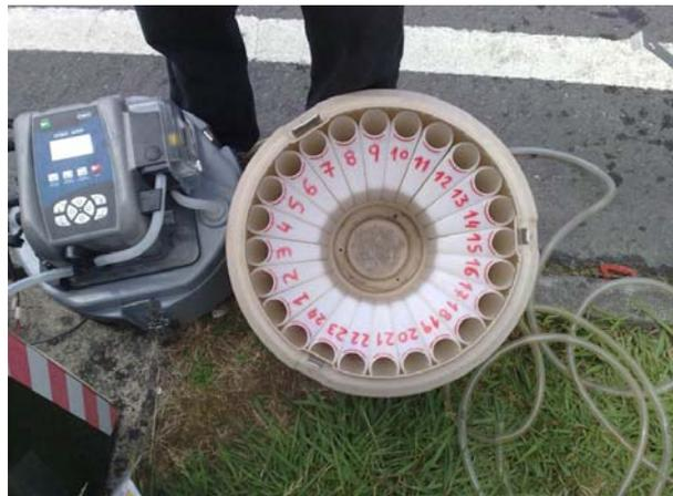
*Figura 8.- Detalle del tomamuestras automático con la unidad de control y la bomba peristáltica de toma de muestras y disposición de las 24 botellas para la toma de muestras.*
