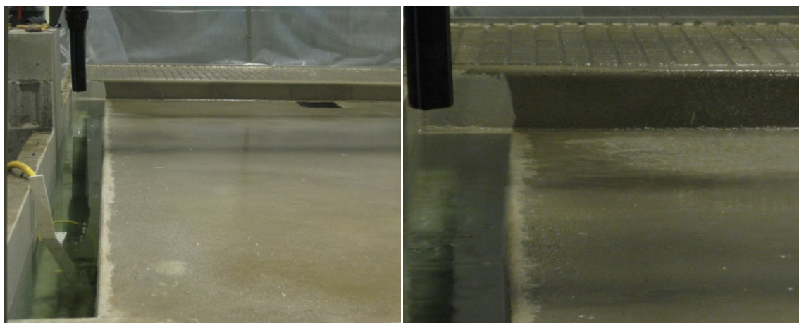
Figura 3.4 Fotografía general del canal de generación de escorrentía (izquierda), y detalle de la zona próxima al bordillo donde se está generando escorrentía en un ensayo (derecha).
