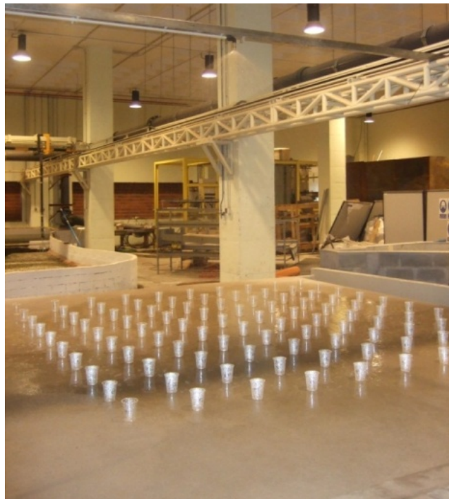
Figura 3.6 Ensayo para la determinación de la distribución espacial de la intensidad de precipitación generada por cada difusor.
